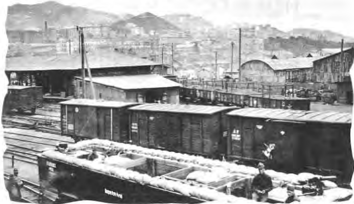
Импровизированный блиндированный «патрульный» поезд американских экспедиционных сил во Владивостоке. Американский вагон-гондола Владивостокской постройки «бронирован» мешками с песком. Вооружение: пулемёты Browning M1917A1 (США)
